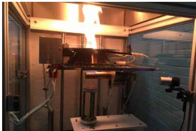
Đốt mẫu thép tấm bằng thiết bị kiểm tra cháy Cone Calorimeter theo tiêu chuẩn ASTM E1354
