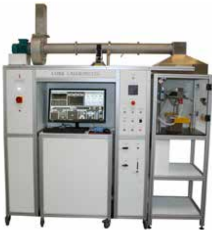
Đốt mẫu thép tấm bằng thiết bị kiểm tra cháy Cone Calorimeter theo tiêu chuẩn ASTM E1354
